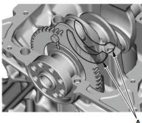
4. 在止推垫圈表面涂抹新的发动机机油。将止推垫圈 (A) 安装到发动机气缸体的 4 号轴颈上。
