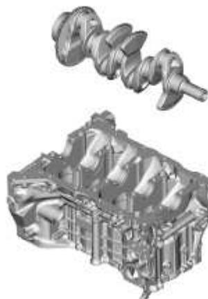
1. 在发动机气缸体和连杆上安装轴瓦。
